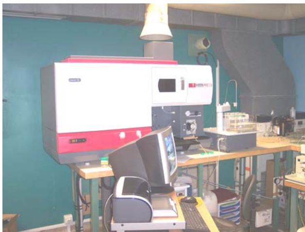
figure 4 : Système d'émission plasma en mode optique
