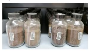
Dans la majorité des cas, les échantillons doivent subir un pré-traitement (séchage, émottage, broyage) pour constituer les échantillons pour essais. Le personnel en charge de la préparation suit pour cela :
